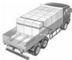
Rys. 5. Mocowanie przez nałożenie czołowe za pomocą zawiesia
